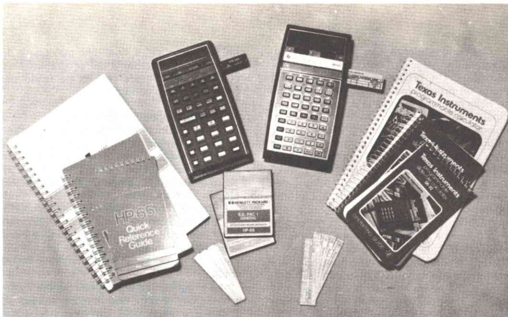
I modelli HP-65 (a sinistra) e SR-52 (a destra) sono due calcolatori portatili interamente programmabili. In entrambi vi è un lettore di cartoline programmatiche miniatura.
