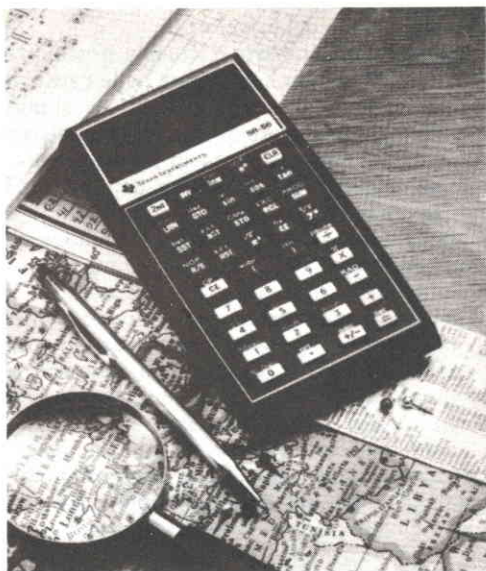
Il modello SR-56 della Texas Instruments è un calcolatore programmabile a 100 operazioni e 10 tasti di memoria.
